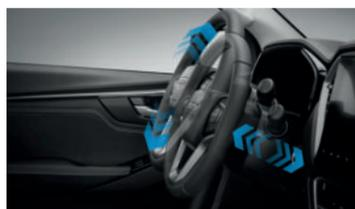
Lenkrad, höhen- und weitenverstellbar
